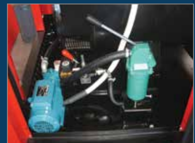
▲ Kit de relleno de combustible automático (más detalle en PAG 7)
