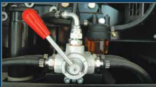
▲ Kit de válvula divertora para tanque de combustible externo
