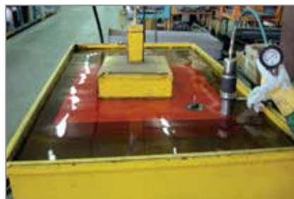
▲ Prueba de detección de fuga de combustible
